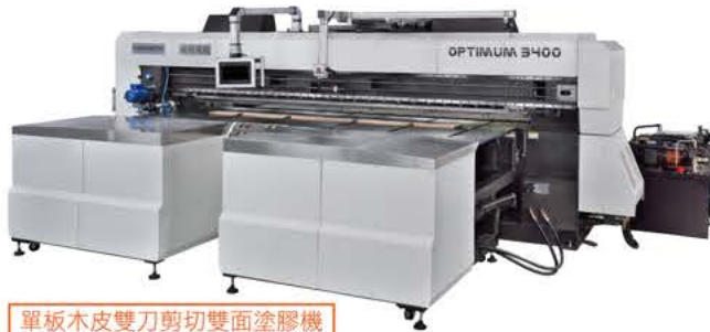
單板木皮雙刀剪切雙面塗膠機 型號:Optimum 系列
